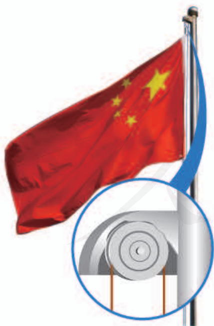
图12.2-2 旗杆顶的定滑轮
