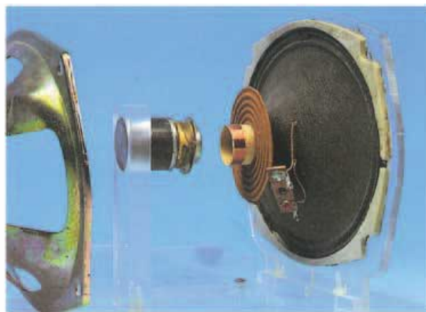
图20.4-8 扬声器的结构
