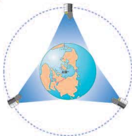
图21.4-5 用三颗同步卫星就可以实现全球通信
