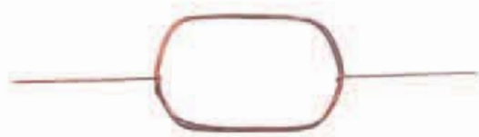
图20.4-3 小小电动机的线圈
