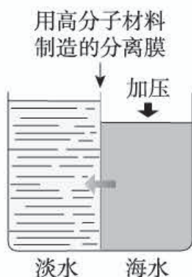
图 12-4 用高分子分离膜淡化海水
