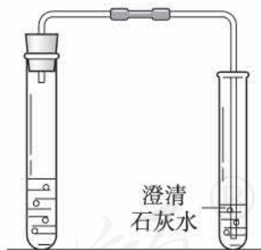
图 11-1 碳酸钠与盐酸反应的装置
