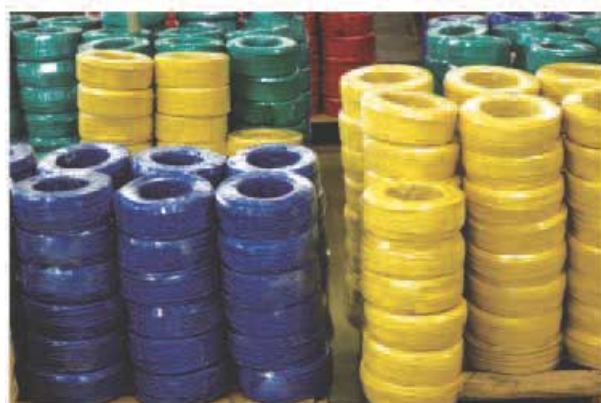
电线外面的绝缘层是 聚氯乙烯塑料
