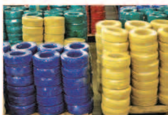
电线外面的绝缘层是 聚氯乙烯塑料
