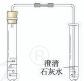
图10-17 碳酸钠与盐酸反应的装置
