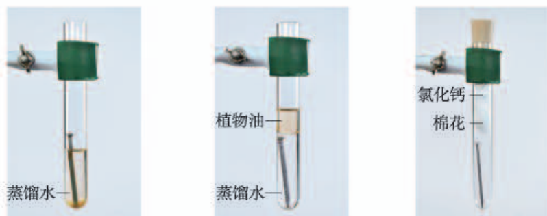
图8-20 铁钉锈蚀条件的探究
