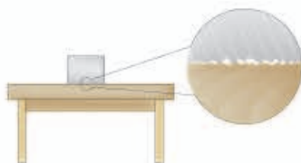
图7.3-1 接触面凹凸不平示意图
