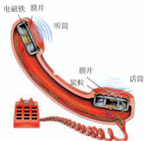
图17.1-3 电话结构示意图
