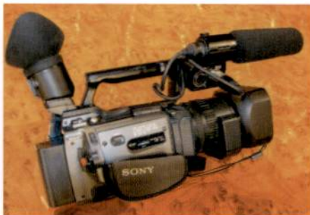
镜头的前一个环是手动聚焦环,后一个环是手动变焦环。
