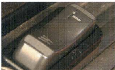
SONY DSR-PD190P 摄像机的变焦按钮。按下W段,将向广角镜头拉开,按下T段,将向长焦推进。
