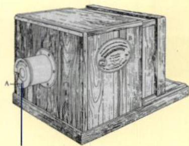
一个可以拨动的金属片,相当于现代照相机的快门。
