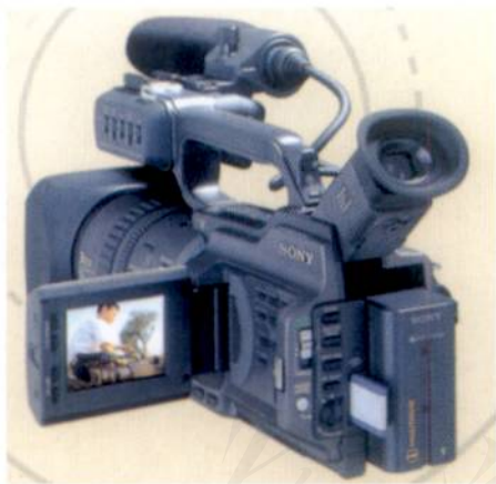
摄像机要防水、防暴晒,不要在粉尘较多的环境打开带仓。镜头不能用普通纸或布擦拭,要用专门的镜头纸擦拭,或用气吹和镜头刷清理灰尘。这是一台SONY DSR-150P专业DV。
