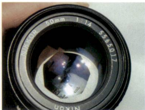
透过镜头表面看到的光圈(分别是调节22、8、4、2时光孔的大小)
