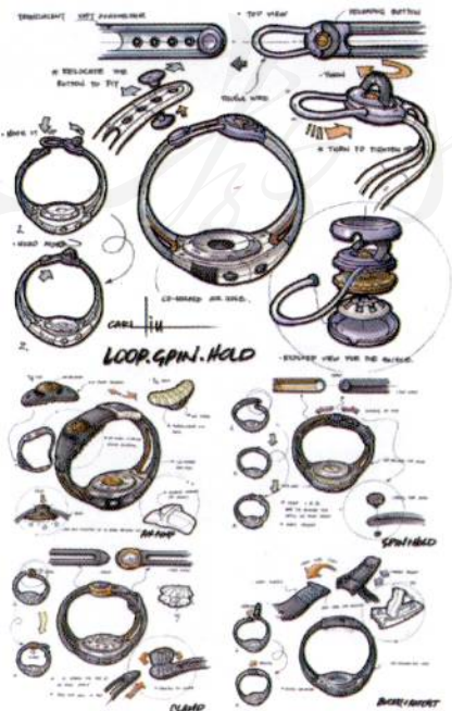
图13 这是Nike运动腕表设计师的进一步深化图。考虑的是种种细节,产品结构和组成方式。有了这些,就能和产品工程师顺利地交接,在最终产品上充分地体现设计师的想法。
