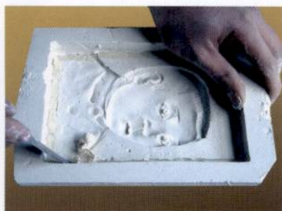
④取出阴模内的泥巴，用肥皂水清洗模具，以起到便于脱模的作用。
