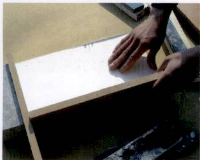
⑦ 待石膏浆凝固发热（约20分钟）后，将木板框架掰开。
