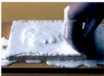
②将石膏浆缓缓倒入泥塑浮雕中，让石膏浆均匀向四周扩散，防止气泡的产生。
