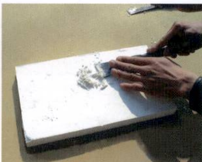
⑧ 待石膏板完全冷却后，用平铲修平。
