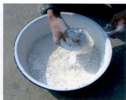
③ 将石膏粉均匀撒入水中，以石膏粉完全浸入水中并刚刚浮出水面为好。
