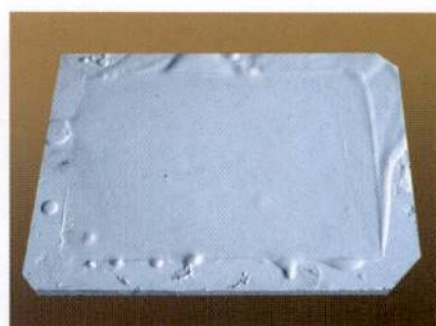
⑥待石膏凝固变硬后，即可用小木棒轻轻敲击模具，使阴阳模逐渐分离。
