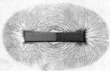
图 1-30 磁铁周围的铁屑分布显示了磁场中的磁力线走向
