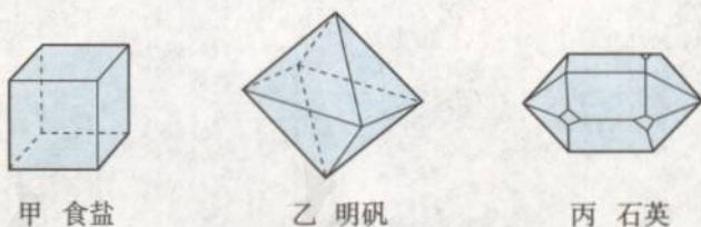
图9.1-2 几种晶体的几何形状
