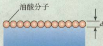
图7.1-1 水面上单分子油膜的示意图
