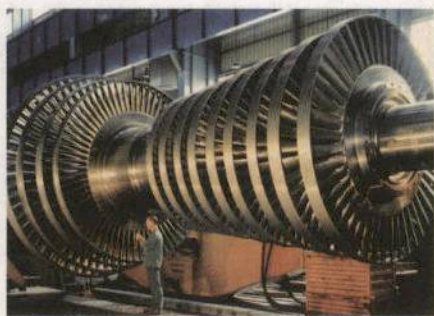
乙 大型汽轮机的叶轮
