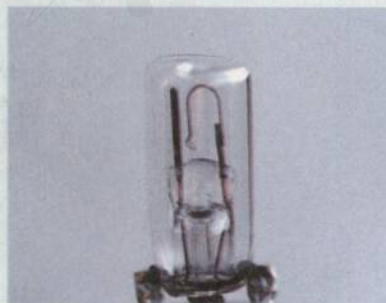
图 6.2-5 日光灯启动器中的双金属片
