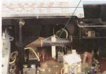
图4.6-1 收音机里的“磁性天线”利用互感现象把广播电台的信号从一个线圈传递到另一个线圈。
