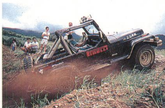
图 7.3-2 汽车爬坡时必须使用低速挡
