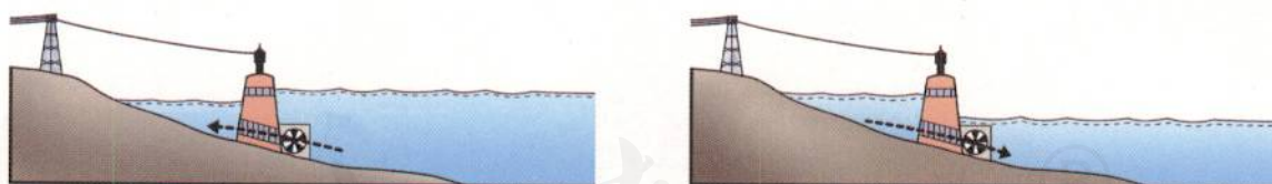
图课-3 潮汐发电的原理
