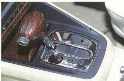
乙 有些汽车的转速比可以根据发动机的转速自动改变,但司机也能通过这个操纵杆进行干预。
