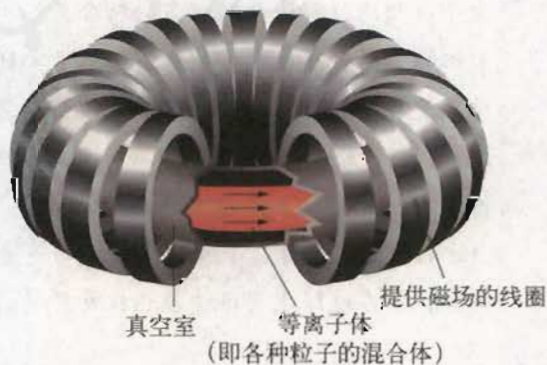
图 19.7-3 环流器的结构
