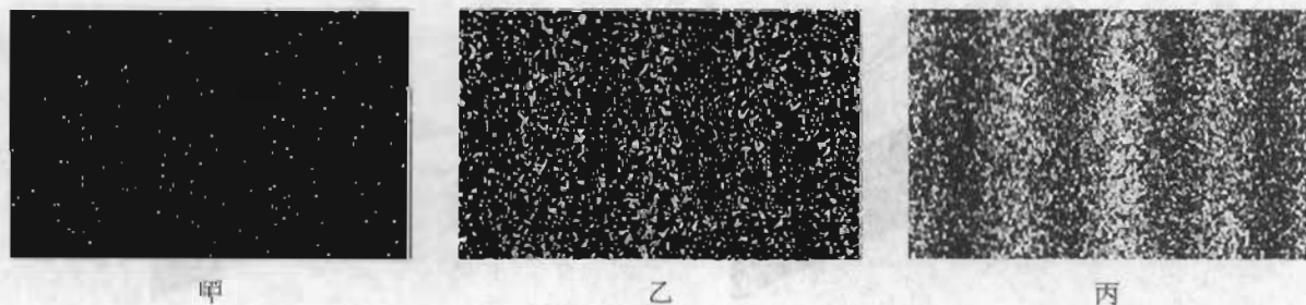
图17.4-2 电子干涉条纹对概率波的验证
