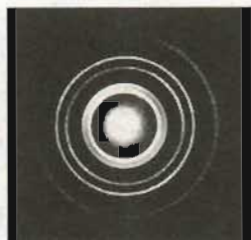
图17.3-1 电子束穿过铝箔后的衍射图样
