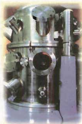
图 19.7-6 用激光引发核聚变的设备
