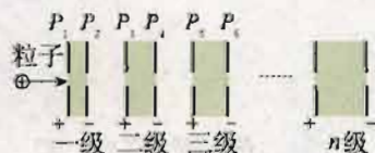
图 3.6-5 多级加速器。各加速区的两板之间用独立电源供电, 所以粒子从 P_2 飞向 P_3 、从 P_4 飞向 P_5 ……时不会减速。
