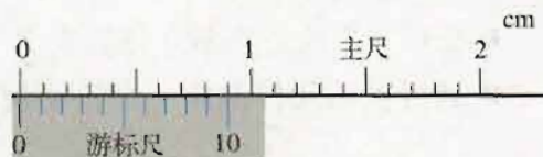
图附-2 游标尺上的小格与主尺上的小格并不等长
