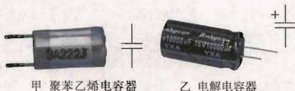
图1.8-5 固定电容器及其符号
