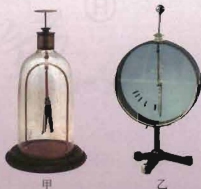
图 1.1-2 验电器和静电计
