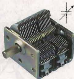
图1.8-6 可变电容器及其符号
