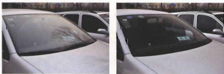
图 13.6-5 相机镜头前的偏振镜可以减弱玻璃表面反射光的影响（右图）
