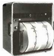
图11.1-6 绘制地震曲线的装置
