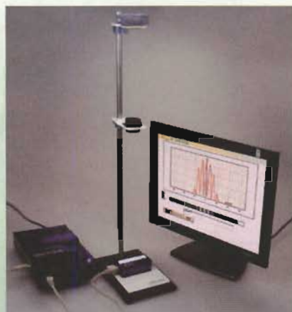
图 13.4-6 用传感器和计算机观察双缝干涉的实验装置
