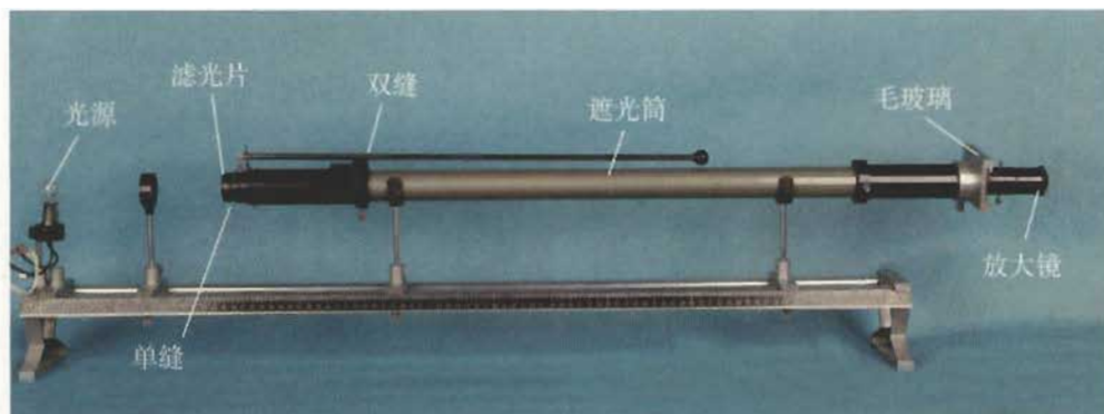
图 13.4-2 双缝干涉的实验装置
