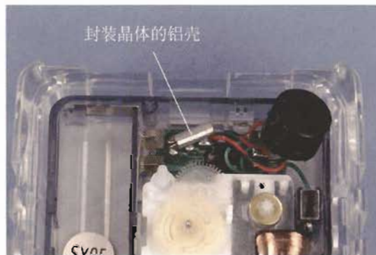
图 14.2-4 石英电子钟的振荡器里用的晶体
