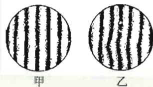
图 13.7-7 从干涉条纹判断被测表面是否平整（图 13.7-6 的俯视图）
