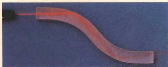
图 13.2-6 弯曲的有机玻璃棒能导光
