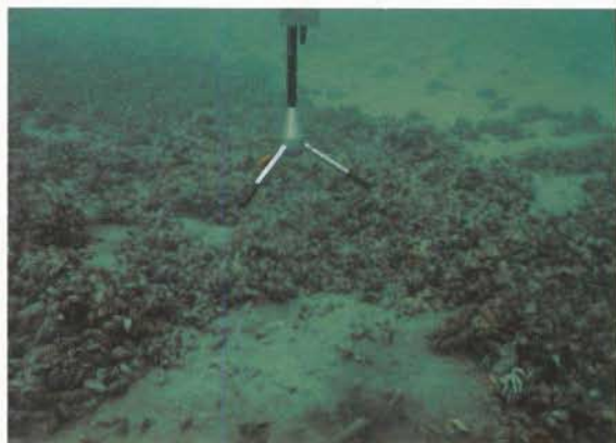
多普勒测速仪测量水在河底的流速,为养殖场寻找适合贝类生长的场所。
