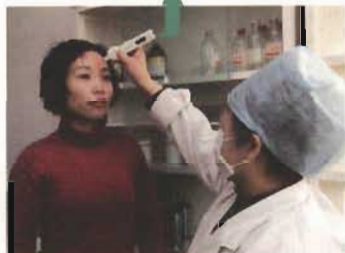
人体在发射红外线,体温越高,发射的红外线越强。根据这个原理,红外体温计不与身体接触也可以测体温。
