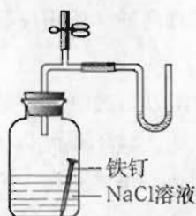
图 4-2 证明空气中的氧气参与反应的实验
