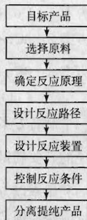
图 2-11 制备物质的一般过程示意图
