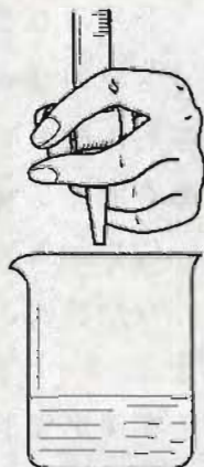
图 3-9 控制酸式滴定管
