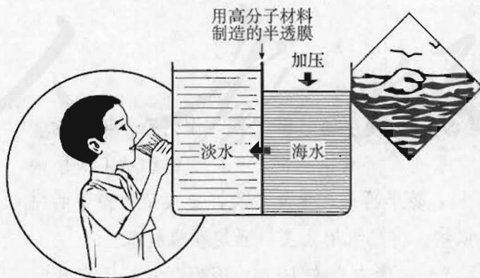
图 2-4 膜分离淡化海水示意图
