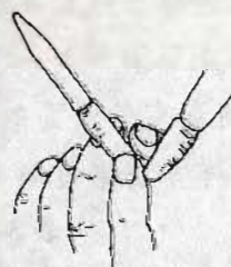
图 3-11 除去碱式滴定管胶管中气泡的方法
