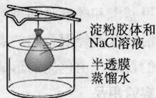
图 2-5 渗析分离实验
