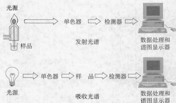
图 3-5 各类光谱仪部件示意图
