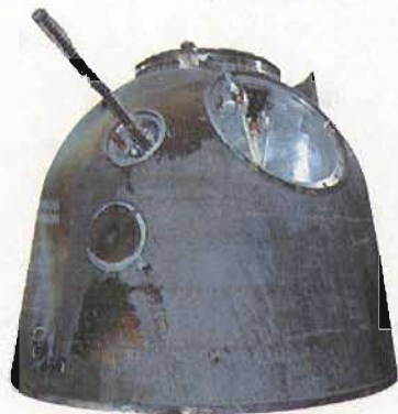
图 5-9 宇宙飞船返回舱烧蚀后的外壳
