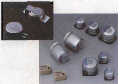
图 5-23 用导电高分子材料制成的电子器件
