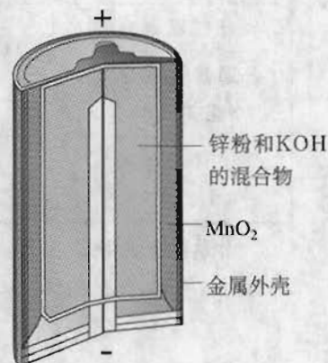
图 4-3 碱性锌锰电池的构造
