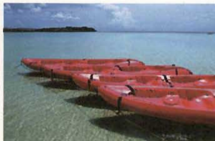
图 3-37 玻璃钢制成的船体
