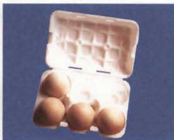
(b) 聚苯乙烯用作包装材料
