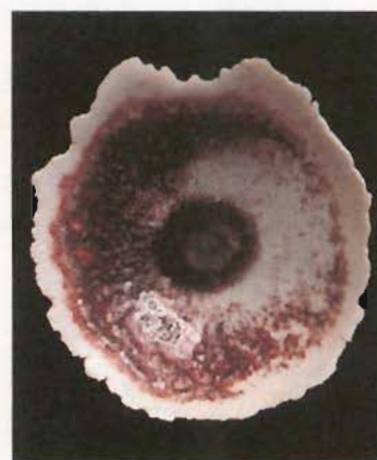
图 3-4 烧结时由于发生氧化还原反应，使艺术陶瓷带有铜的血红色图样
