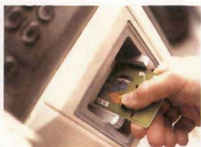
(a) 聚氯乙烯用作电话卡基体
