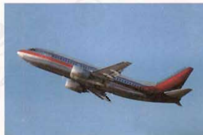
图 3-6 硬铝常用于制造飞机的外壳
