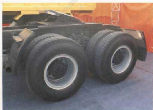
图 3-43 硫化后的橡胶适合制造汽车轮胎，加入炭黑可增强轮胎的耐磨性
