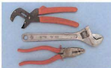
某些工具的“机械转动部位”选用油脂来防锈，为什么不能用油漆
