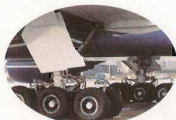
图 3-11 由钛、钒、铁和铝组成的钛合金常用于制造飞机的起落架
