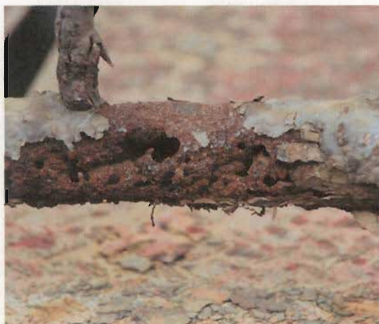
钢铁生锈（铁锈的主要成分是 \text{Fe}_2\text{O}_3 \cdot x\text{H}_2\text{O} ）
