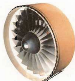
图 3-12 喷气式飞机的发动机叶片是由镍、铁、碳和钴组成的镍钴合金制造的，能承受 1\,200\,^{\circ}\text{C} 的高温
