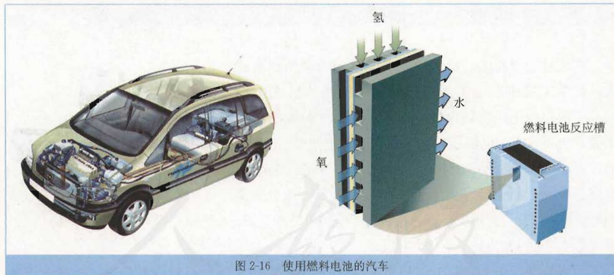
图 2-15 氢氧燃料电池构造示意图
