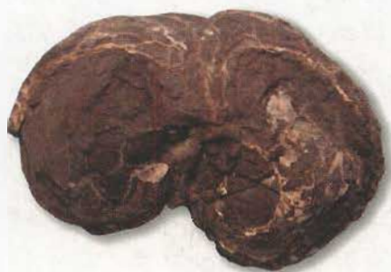
图 4-2 海底多金属结核矿含有铁、锰、钴等多种金属元素
